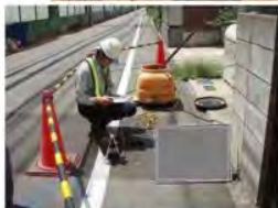
地下水位観測
